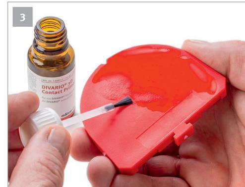
Den **DIVARIO® 3D Primer** (Art.-Nr. 14601) mit dem Pinsel gleichmäßig auf die ganze Oberfläche der **DIVARIO® Sockelplatte** auftragen und ca. 1 Minute ablüften lassen.
