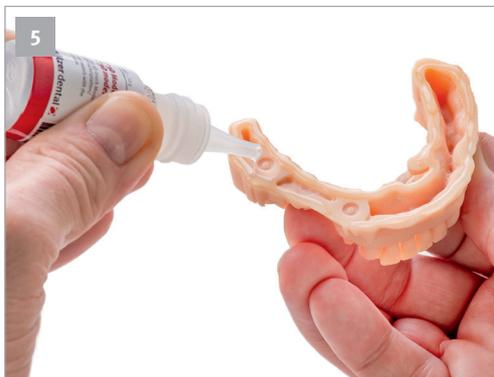
Den **DIVARIO® 3D Modellkleber** (Art.-Nr. 14602) gleichmäßig in ausreichender Menge auf die Unterseite des 3D-Druckmodells auftragen, damit mögliche Spalten zwischen dem 3D-Modell und der **DIVARIO® Sockelplatte** durch den Kleber aufgefüllt werden können.
