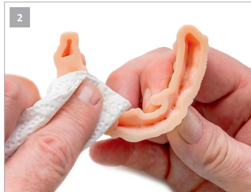
Den **DIVARIO® 3D Oberflächenreiniger** auf ein sauberes Tuch oder Vlies aufsprühen und damit die Rückseite des 3D-Druckmodells reinigen.
