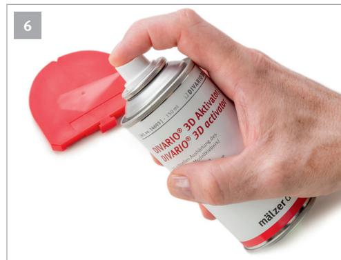
Nun den **DIVARIO® 3D Aktivator** (Art.-Nr. 14603) aus ca. 30 cm Entfernung gleichmäßig und dünn auf die **DIVARIO® Sockelplatte** aufsprühen und ca. 30 Sekunden ablüften lassen, bis die Oberfläche sichtbar matt ist.
