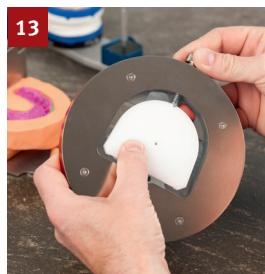
Fissare la piastra zoccolo sul disco portapiastre del foragessi.
