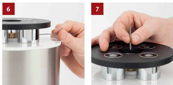
Mettre l'appareil hors tension et débrancher la prise de secteur. A l'aide de la clé six pans fournie, desserrer les deux vis de réglage de la broche en laiton et sortir le foret vers le haut.
