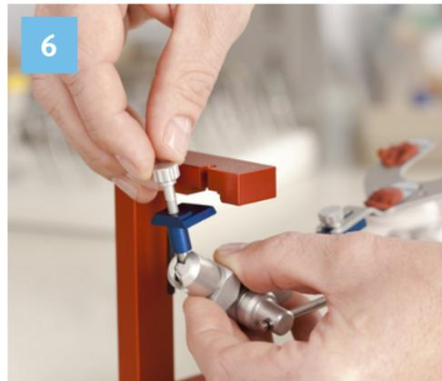
6 Gelenksupport leicht schräg in die dafür vorgesehene Aufnahme des Übertragungstisches setzen und die Bissgabel in den Gipsbrei legen.
