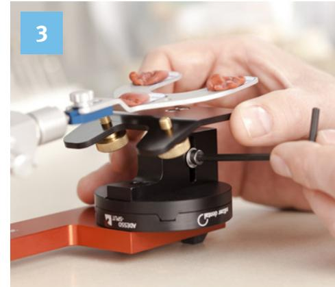
3 Übertragungstisch in Position bringen. Der Abstand zwischen Bissgabel und Retentionsschrauben soll ca. 5 mm betragen. Der Übertragungstisch ist durch Lösen der Inbuschraube in der Höhe verstellbar.
